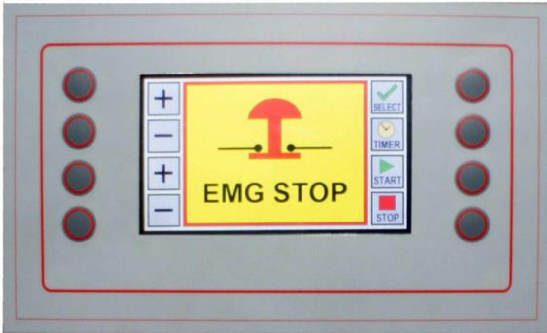
Fig 9. Butonul de oprire de urgenta este activat. EMG STOP
