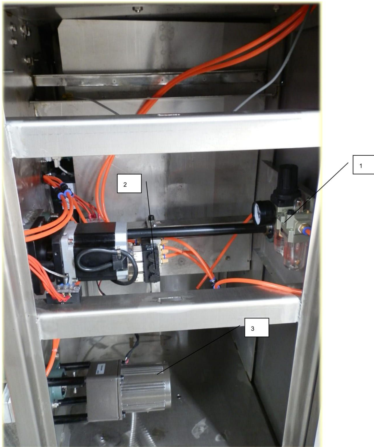
① Manometru ② Valva selenoida ③ Motor pentru transportor
