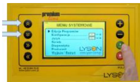
Fig.14. Prin intermediul butoanelor SĂGEATĂ SUS / SĂGEATĂ JOS, selectați elementul relevant din meniul Confirmare prin butonul START - introduceți funcția relevantă.
