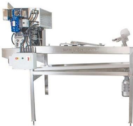
Fig 2. Cadru de alimentare cu brat de incarcare
