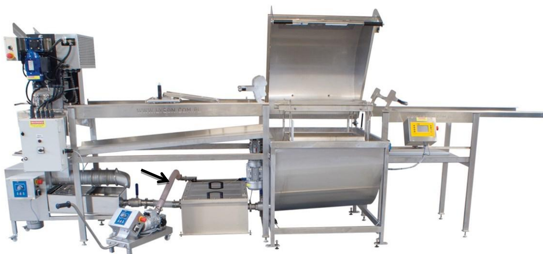
Fig.11. Linia ‘OPTIMA - FULL’ pompă de miere conectata la mașină de descapacit, filtru cu site izolat, și extruder,conectata cu furtunul de conectare indicat cu sageata.
