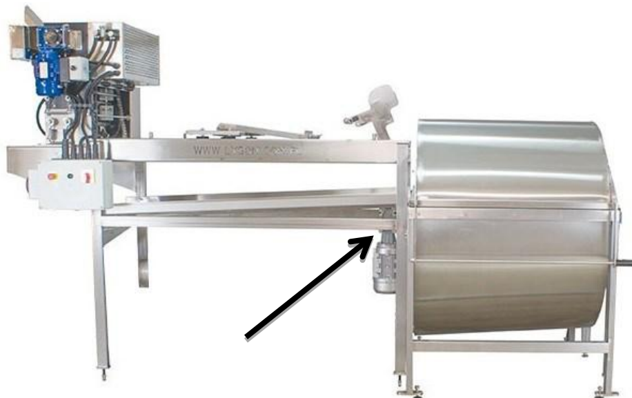
Fig.3. Fixarea cadrului alimentatorului cu brat, pe extractor
