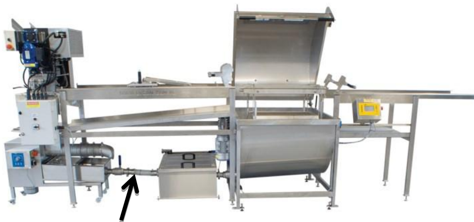
Fig.10. Linia de extracție cu mașină de descapacit, filtru cu site și extruder, sunt conectate cu furtun , indicat cu sageata
