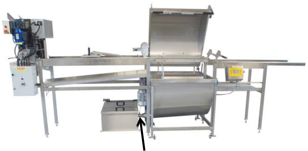
Fig.7. Linia de extracție cu descapacitor și un filtru cu site izolat
