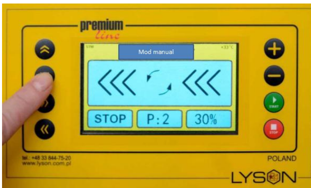
Fig.5 prin intermediul butonului: „SĂGEATĂ ÎN SUS” sau „SĂGEATĂ JOS ”selecțați PROGRAM P: 1 sau P: 2 (direcția de rotație a coșului) Apoi apăsați butonul START ca în Fig.6
